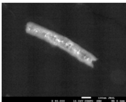
Rus. 1. Obraz SEM nanorurek wypełnionych azotanem ceru. Obraz został wykonany w trybie "compo" (elektrony odbite). W tym trybie jasność obrazu jest proporcjonalna do z^2 , gdzie z to liczba atomowa pierwiastka obecnego na powierzchni. Ponieważ cer ma liczbę atomową znacznie większą od węgla, obszary o dużym stężeniu ceru wydają się być jaśniejsze. Obraz świadczy o tym, że cer znajduje się głównie wewnątrz nanorurek.
