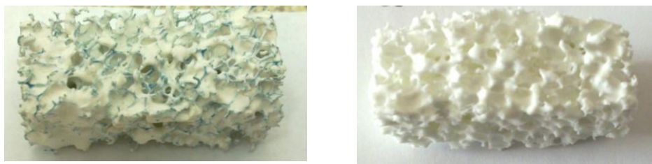
Rys. 1. Szkielet poliuretanowy pokryty masą ceramiczną (lewy) i przykładowa pianka ceramiczna (prawy)
