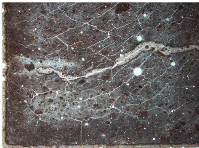
Rys. 1. Zdjęcie mikroskopowe w świetle przechodzącym wykonane dla zaczynu pielęgnowanego przez 28 dni w 100% wilgotności względnej. Widoczna jest większa ilość spękań w strefie środkowej zaczynu.
