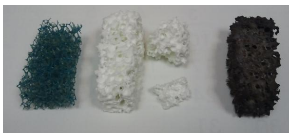
Rysunek 1. Pianka poliuretanowa, pianka ceramiczna po spiekaniu, katalizator piankowy (od lewej do prawej)
